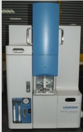
Dosage de la teneur en élément (H, C, N, O et S) directement sur échantillon massif ou sous forme de poudre.
