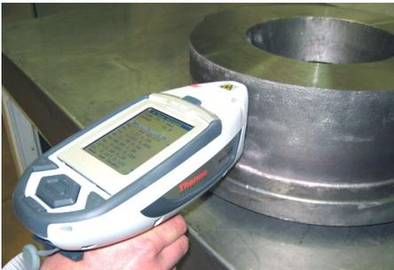
*Spectromètre portable à fluorescence X*
