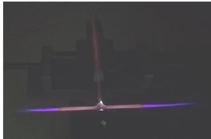
Figure 4 Plasma-Gun : Génération d'un Plasma 'volumique' à la pression atmosphérique dans un tube 'T'
