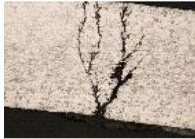
Autre zone observée après attaque chimique : présence d'une fissure
