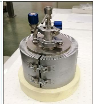
Figure 5 Systèmes de vaporisation de précurseurs pour dépôt CVD
