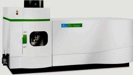
Dosage des éléments présents dans une solution obtenue après dissolution complète par attaque chimique d'un échantillon qui peut être initialement massif ou sous forme de poudre.
